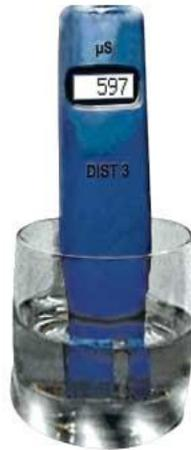
Messinstrument: Leitwert des Wassers in  $\mu\text{S}$
